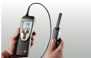
Наконечник зонда влажности, прикрепленный к рукоятке через кабель зонда
