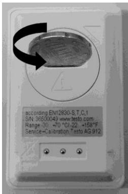
2. Откройте крышку аккумуляторного отсека логгера данных поворотом влево и снимите её.
