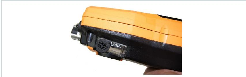
**⚠ ОСТОРОЖНО****Конденсат – смесь кислот в низкой концентрации!****Возможность получения травмы!**
