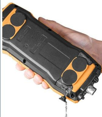
3 - Протрите сливное отверстие конденсатосборника тканью и закройте его.
