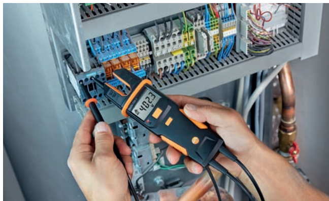
Проверка напряжения на тепловом насосе с testo 755
