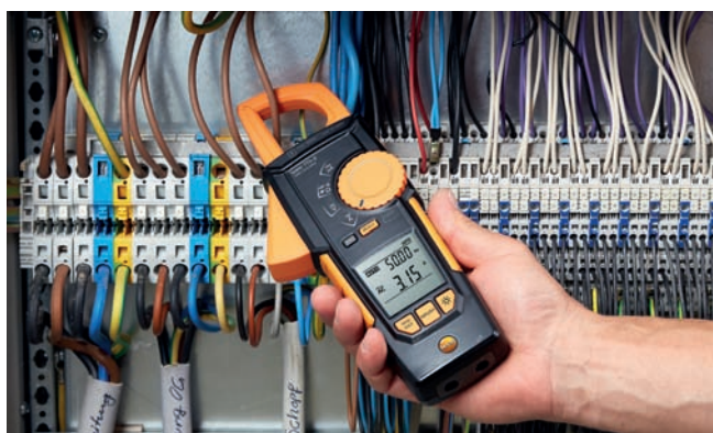
Измерение силы тока в распределительном щитке
