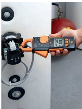
Измерение напряжения на бойлере с testo 770
